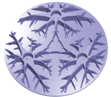
图6 反射镜拓扑优化方案构型 Fig.6 Configuration of mirror topology optimization scheme
