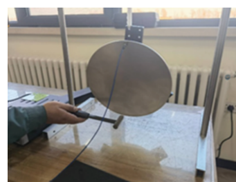
图10 反射镜模态频率测试状态
