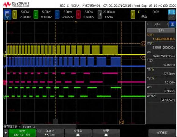
图 13 调焦电机减速段
