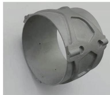
图 13 打印完成的连接筒
