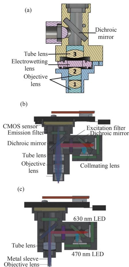
图 5 具有双色成像功能的系统。(a) MiniScope V4 的横截面图; (b) DCFIMM-SBI 的横截面图<sup>[35]</sup>; (c) DCFIMM-DBI 的横截面图<sup>[35]</sup>
