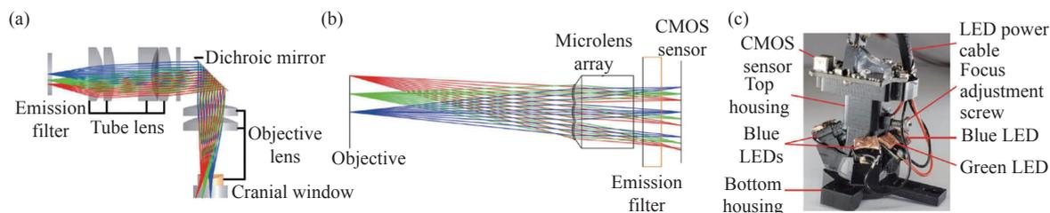
图 6 现有的大视场系统。(a)cScope 的成像路径光路图<sup>[36]</sup>; (b)CM<sup>2</sup> 的成像路径光路图<sup>[37]</sup>; (c)完全组装的 mScope<sup>[46]</sup>
