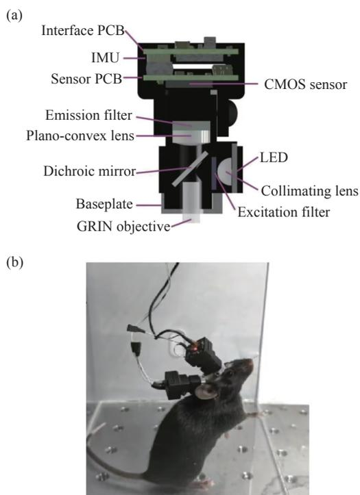
图 4 具有双区域成像功能的系统。(a) NINscope 的主体和内部光学元件布局图<sup>[31]</sup>; (b) 一只安装了两个 NINscope 的小鼠<sup>[31]</sup>
