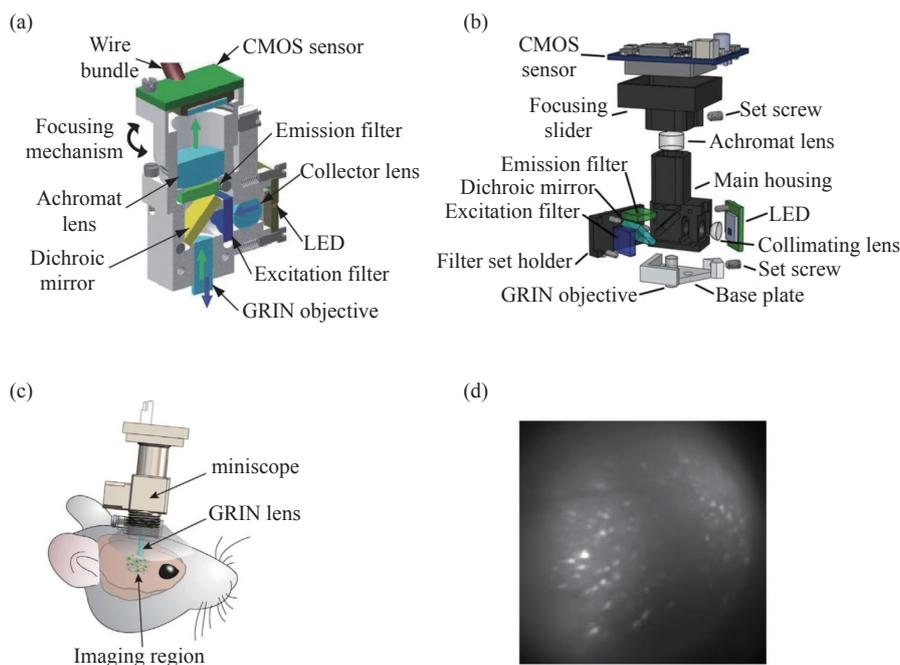
图 1 具有基本成像功能的系统。(a)Ghosh 等人的集成显微镜的横截面图<sup>[9]</sup>; (b)MiniScope V3 的分解图; (c)戴着微型显微镜的小鼠示意图<sup>[14]</sup>; (d)小鼠大脑中神经元活动的荧光图像<sup>[14]</sup>
