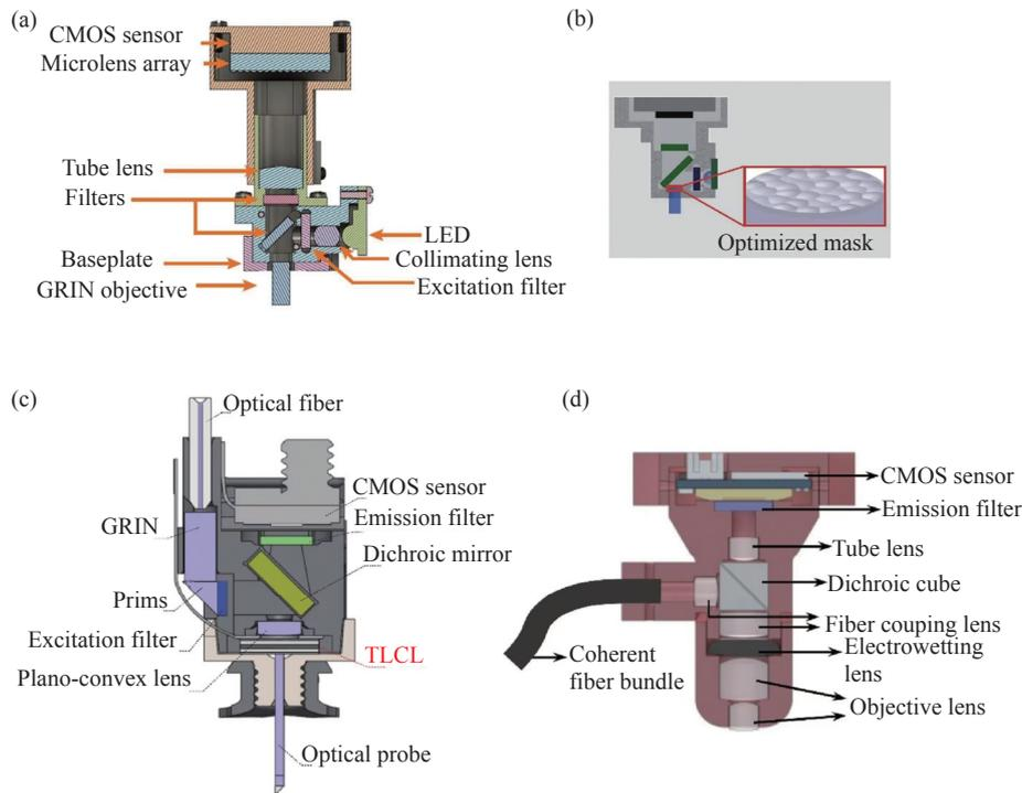
图 3 具有三维成像功能的系统。(a)MiniLFM 的横截面图<sup>[24]</sup>; (b)Miniscope3D 的横截面图<sup>[27]</sup>; (c)Bagramyan 等人的显微镜横截面图<sup>[28]</sup>; (d)SIMScope3D 的横截面图<sup>[29]</sup>
