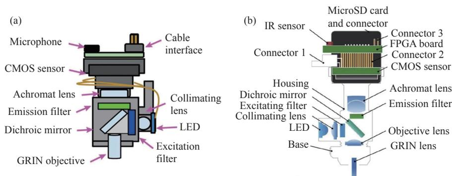
图 2 具有无线功能的系统。(a) FinchScope 的横截面图<sup>[19]</sup>; (b) 无线 miniscope 的内部光学元件布局图<sup>[22]</sup>
