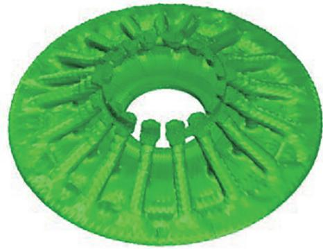
图 6 直径为 210 mm 的铝合金反射镜的拓扑优化结果
