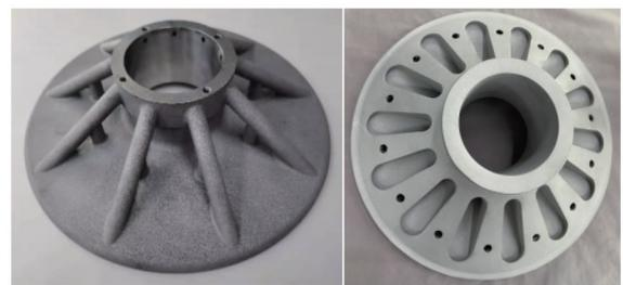
图 9 基于增材制造的铝合金反射镜
