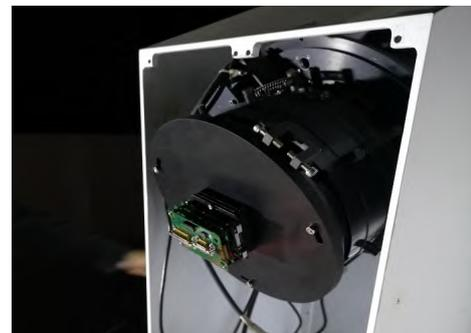
图10 CMOS成像电路板安装在基地镜筒上
