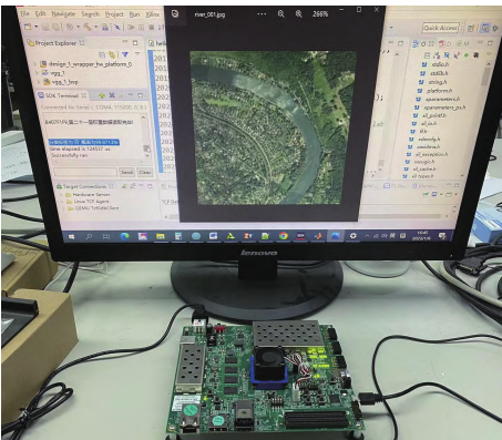
图 12 ZCU104 硬件平台测试图 Fig. 12 ZCU104 hardware platform test diagram
