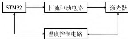
图 1 半导体激光器驱动电路
