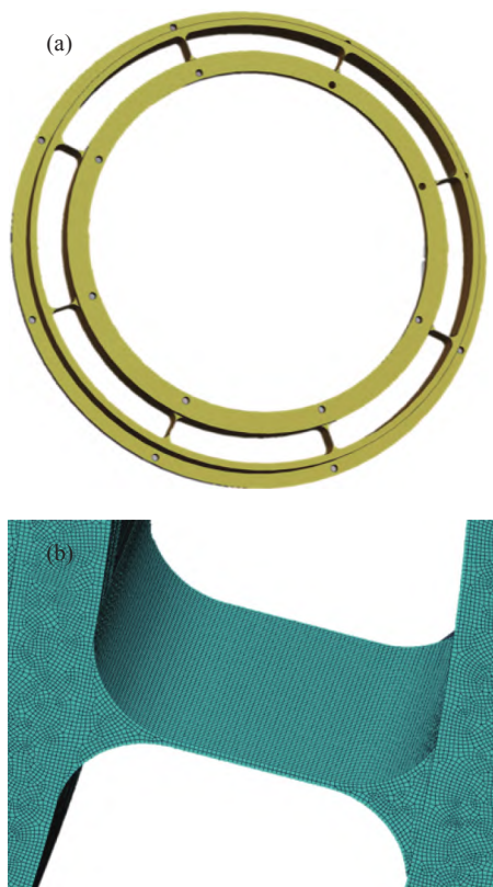
图 10 (a) 优化后的像旋补偿机构; (b) 像旋补偿机构有限元模型
