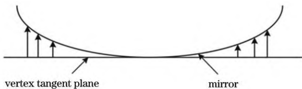
图 1 矢高位移 Fig. 1 Sag displacements
