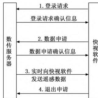
图 6 网络连接通信流程
