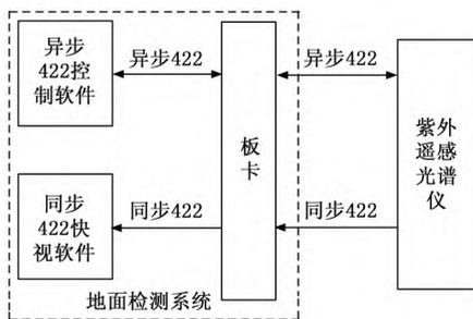
图 2 地面检测系统结构图
