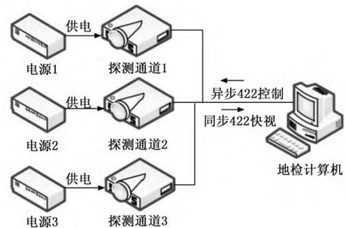
图 9 成像单机测试环境原理图
