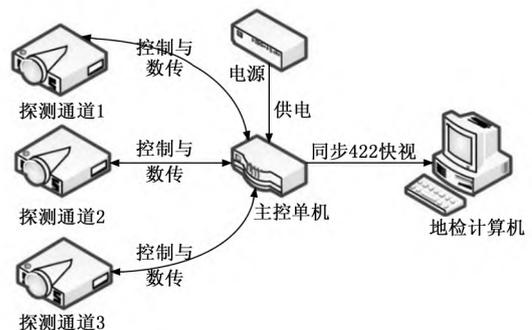
图 10 整机测试环境原理图
