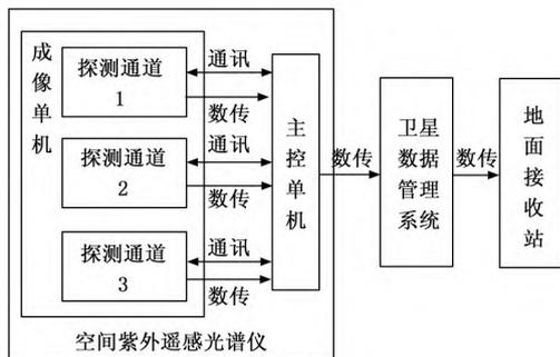
图 1 紫外遥感光谱仪数据流向图
