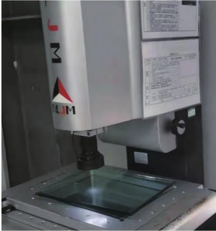
图25 二次元测量仪
